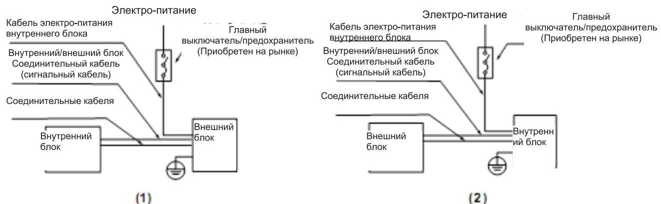
**Примечание:** Электро-питание кондиционера воздуха может быть различном в зависимости от модели. Смотрите ИНСТАЛЯЦИОННУЮ СХЕМУ вставленную на внутреннем и внешним блоков перед подключении кабелей.
