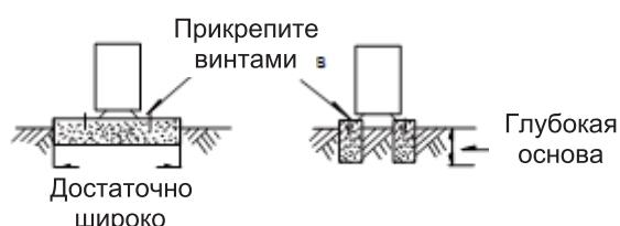
Прикрепите основу устройства болтами (M10). Обеспечьте достаточно прочное крепление устройства против взрыва и землетресения.
